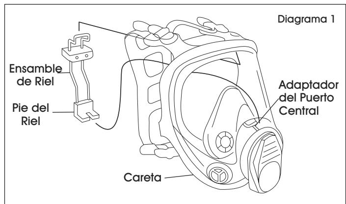
2. Coloque el ensamble de la montura sobre el ensamble de riel insertando los pasadores en los orificios del deslizador de caucho.
