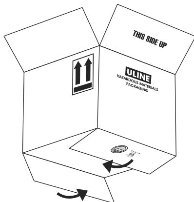
1. Doble las solapas de la parte inferior de la caja de cartón de forma que coincidan. La certificación del fabricante debe quedar a la vista en la parte exterior de la caja. (Vea Diagrama 1)
