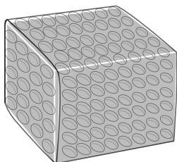
4. Envuelva la bolsa de aire completamente en burbuja antiestática de 3/16" (No. de modelo de Uline S-396). (Vea Diagrama 4)
