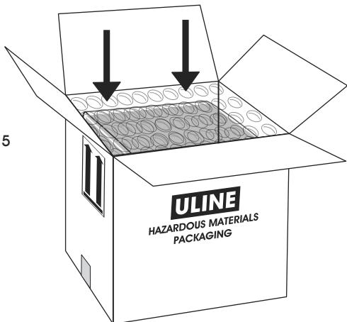
5. Coloque la bolsa de aire envuelta en burbuja en el centro de la caja. Rellene cualquier espacio vacío con burbuja antiestática de 3/16" (No. de modelo de Uline S-396). (Vea Diagrama 5)
