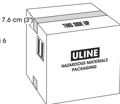
6. Doble las solapas de la parte superior de la caja de cartón de forma que coincidan. La advertencia "THIS SIDE UP" (Este lado hacia arriba) debe quedar a la vista en la parte exterior de la caja.
