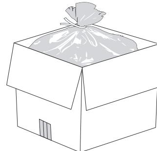
5. Vierta una capa uniforme de un mínimo de 9.88 cm (3.89") de Vermiculita Grado 4 en el fondo de la bolsa de polietileno.
