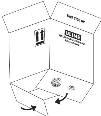
3. Selle la base de la caja de cartón con tres tiras paralelas de cinta de polipropileno de 5 cm (2") de ancho (2.6 mil) (Uline Modelo # S-14564). La cinta debe traslaparse 1.3 cm (0.5") de lado a lado y extenderse 7.6 cm (3") sobre cada uno de los extremos de la caja de cartón. (Vea Diagrama 2)
