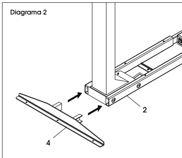
4. Inserte dos tornillos para máquina M6 x 33 mm (9) en los orificios del extremo del armazón para conectar el armazón ajustable con las columnas de elevación y el brazo de soporte superior. Apriete ligeramente con la llave hexagonal de 5 mm (17). Luego apriete ligeramente dos tornillos para máquina M6 x 33 mm preinstalados (9) para asegurar la columna de elevación. Repita este paso en el lado opuesto. (Vea Diagrama 3)
