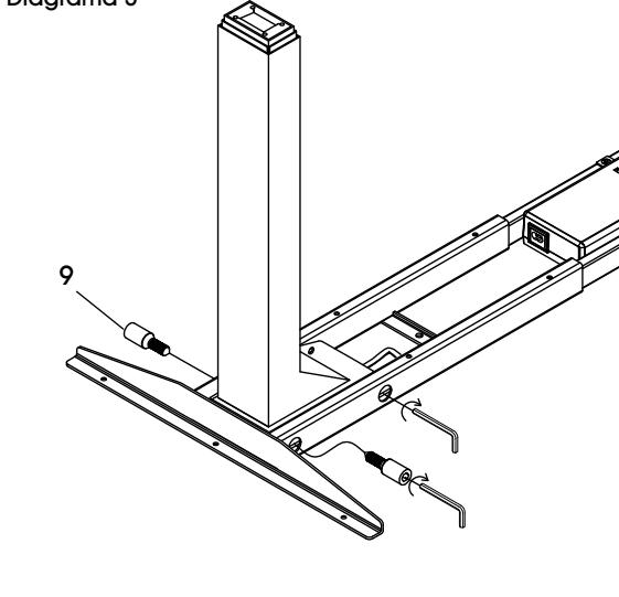
5. Coloque la pata (3) a la columna de elevación con cuatro tornillos para máquina M6 x 15 mm (10). Apriete con la llave hexagonal de 4 mm. Repita este paso en el lado opuesto. (Vea Diagrama 4)
