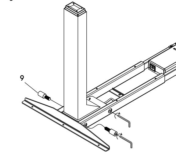
5. Fixez la patte (3) à la colonne de levage en utilisant quatre vis à métaux M6 x 15 mm (10). Vissez avec la clé hexagonale de 4 mm. Répétez cette étape sur le côté opposé. (Voir Figure 4)
