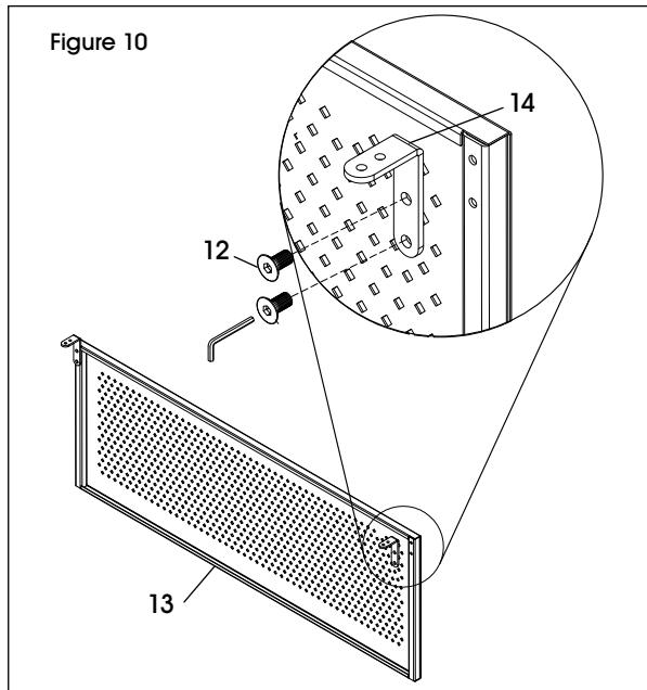
13. Placez le panneau cache-jambes en métal (13) de façon à ce qu'il soit centré avec le cadre à l'arrière de la surface de bureau. Fixez les supports du panneau cache-jambes avec deux vis à bois de M5 x 20 mm (11) par support. (Voir Figure 11)
