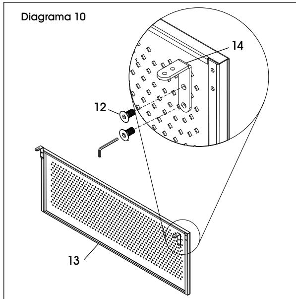
13. Centre el panel de metal para privacidad (13) entre los brazos de soporte en la parte posterior de la cubierta. Fije los soportes del panel de privacidad (14) usando dos tornillos para máquina de M5 x 20 mm (11) por soporte. (Vea Diagrama 11)
