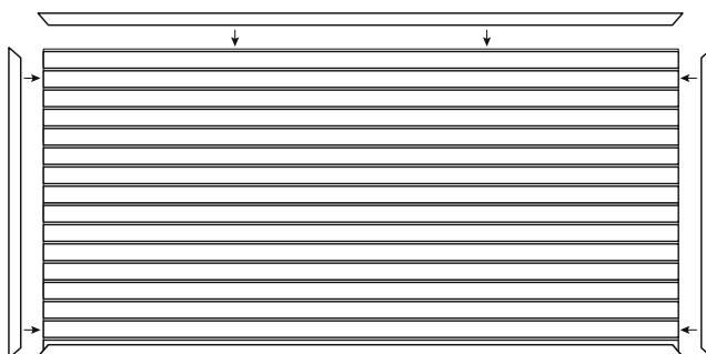
6. Faites glisser en place les trois garnitures en J coupées en onglet restantes. Ajustez jusqu'à ce que les coins s'emboîtent. Serrez toutes les vis au mur. (Voir Figure 6)
