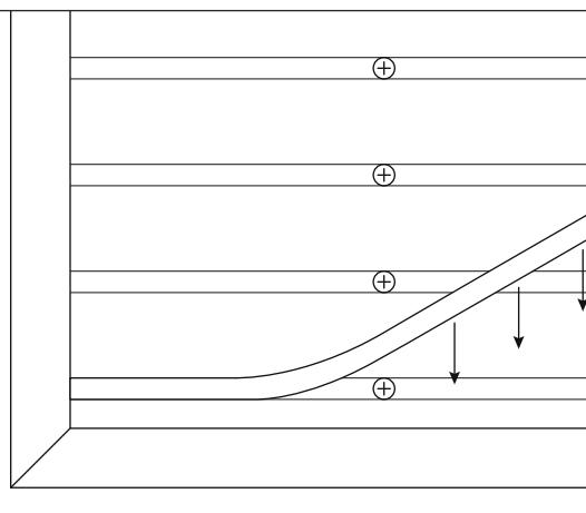
7. Para ocultar por completo las cabezas de los tornillos, retire el respaldo de las tiras adhesivas de color y presione en cada ranura de los paneles. (Vea Diagrama 7)
