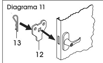
Coloque el pasador de chaveta (13) a través del orificio del vástago cuadrado. (Vea Diagrama 12)
