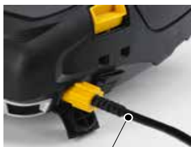
Figura 10: Comunicación de cable con PC
