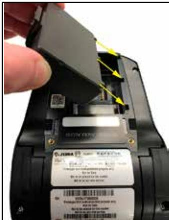
3. Insérez la batterie dans l'imprimante tel qu'ilustré. (Il n'est pas possible d'insérer la batterie dans le mauvais sens.)
