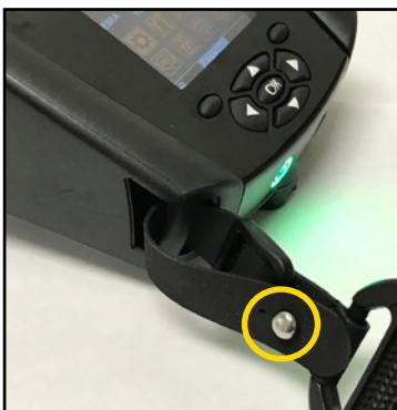
2. Inserte el orificio en el extremo de la correa sobre el montante metálico (marcado con un círculo) para asegurarlo.
