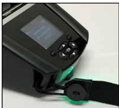
2. Enroulez l'extrémité de la dragonne autour de l'encoche et fixez-la en place à l'aide du bouton.
