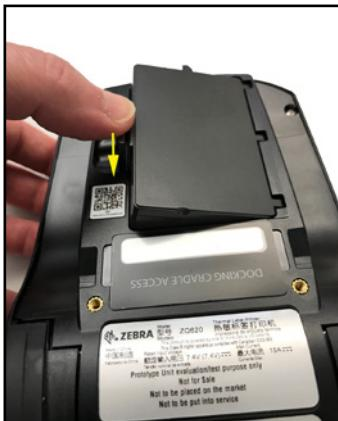
4. Mueva la batería en el compartimento, como se muestra, hasta que quede fija en posición.
