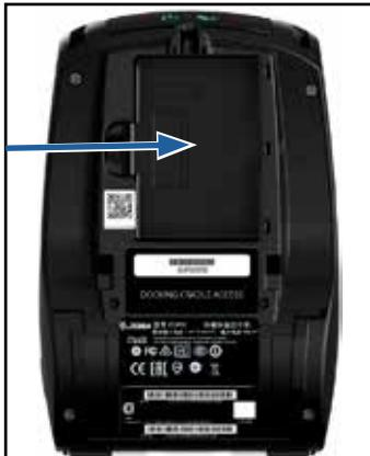
2. Faites pivoter le clip de ceinture (le cas échéant) pour accéder au compartiment de la batterie.
