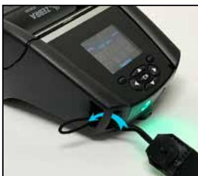
1. Faites passer la boucle située à l'extrémité de la dragonne à travers l'encoche à l'avant de l'imprimante, comme illustré.
