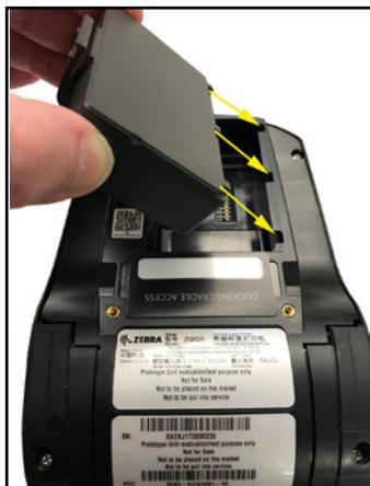
3. Inserte la batería en la impresora como se muestra.
