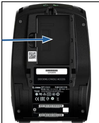
2. Gire el sujetador de cinturón (si está presente) para tener acceso al compartimiento de la batería.
