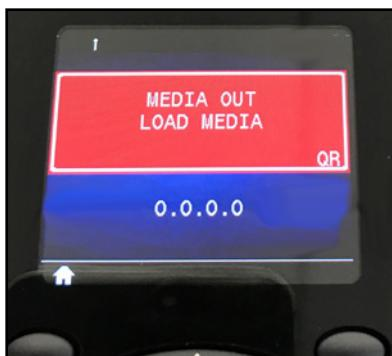
El usuario puede responder a las acciones presionando una de las teclas de función para indicar que ya se ha tomado una medida para resolver la alerta en cuestión. Después de que la condición causante de la alerta ha sido resuelta (es decir, la carga del papel), se borrará el mensaje de alerta. (Consulte el Apéndice G para ver la lista completa de alertas disponibles en las impresoras ZQ6).
