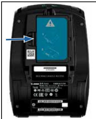
3. Faites pivoter la batterie pour l'extraire de son compartiment. Extrayez la batterie de l'imprimante en la soulevant.
