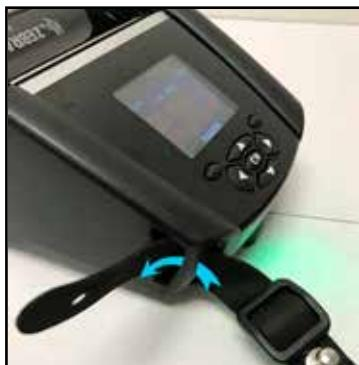
1. Insérez l'extrémité de la bandoulière derrière l'encoche située sur le côté avant de l'imprimante et enroulez-la autour de l'encoche.
