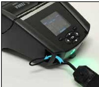
1. Introduzca el lazo en el extremo de la correa a través de la ranura ubicada en la parte delantera de la impresora como se muestra a continuación.
