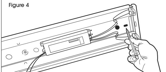
5. Coupez l'alimentation et tenez le luminaire près de la boîte de sortie, puis tirez les fils dans le boîtier du luminaire et à travers le trou de l'alvéole défonçable. (Voir Figure 5)
