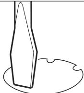
4. Soulevez le boîtier du luminaire au plafond tout en centrant l'alvéole défonçable par-dessus la boîte de sortie et en restant parallèle aux murs. À l'aide d'un crayon, tracez des repères pour les trous de montage à travers les fentes de 0.64 x 0.95 cm (1/4 x 3/8 po). Percez des avant-trous de 0.32 cm (1/8 po) à chaque endroit. Si la perceuse n'atteint pas la solive du plafond, élargissez le trou au plafond pour accommoder le boulon à ailettes. (Voir Figure 4)
