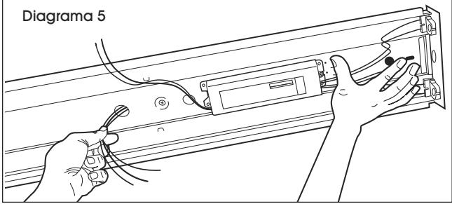
7. Con la corriente eléctrica apagada, realice las conexiones de suministro de electricidad. Una el cable a tierra al tornillo verde a tierra; luego, conecte los cables de suministro, negro al negro y blanco al blanco con conectores para cables. (Vea Diagrama 7)
