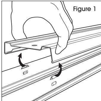
2. Placez les ensembles des rampes dans les fentes à l'extrémité du profilé.
