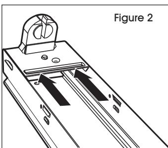
3. Tirez les rampes vers l'extrémité du profilé pour les verrouiller en position. (Voir Figure 2)
