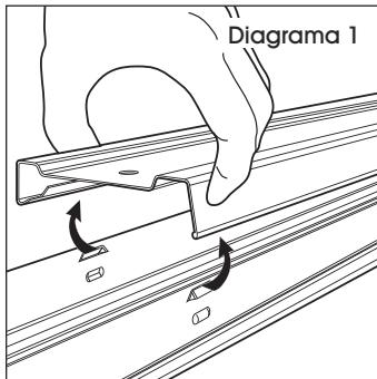
2. Coloque los ensambles del carril dentro de las ranuras en el extremo del canal.
