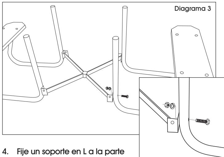
4. Fije un soporte en L a la parte exterior de cada una de las patas con la brida apuntando hacia fuera de la mesa usando un perno hexagonal de 2½". Fije usando una rondana plana, una rondana de seguridad y una tuerca hexagonal. (Vea Diagrama 4)
