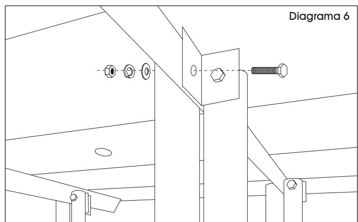
8. Fije la parte inferior de las patas al soporte en X usando pernos hexagonales de 2½". Fije usando una rondana de seguridad y una tuerca hexagonal.
