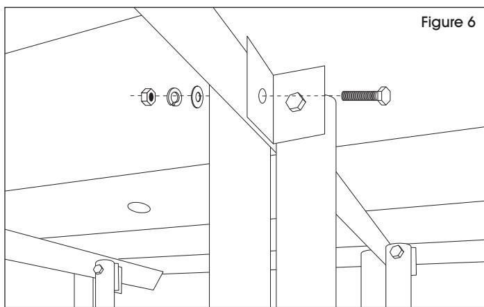
8. Raccordez le bas des pattes au croisillon à l'aide de boulons à tête hexagonale de 2 1/2 po. Fixez-les fermement en place à l'aide d'une rondelle de blocage et d'un écrou hexagonal.
