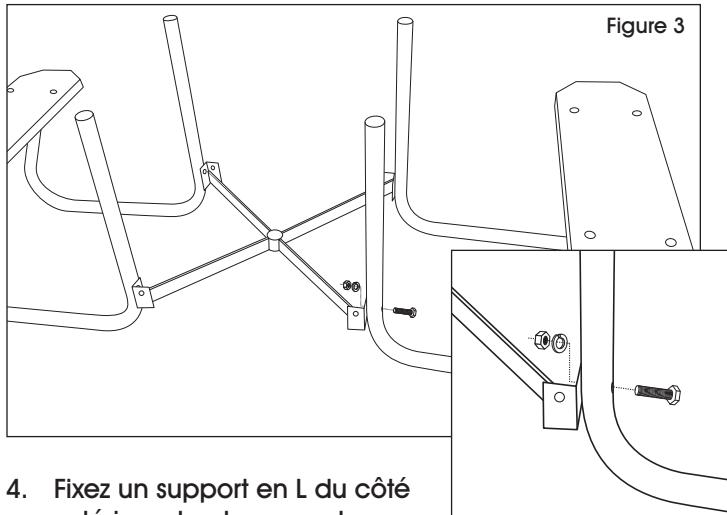
4. Fixez un support en L du côté extérieur de chacune des pattes, avec la bride orientée vers l'extérieur de la table, à l'aide d'un boulon à tête hexagonale de 2 1/2 po. Fixez le tout à l'aide d'une rondelle plate, d'une rondelle de blocage et d'un écrou hexagonal. (Voir Figure 4)
