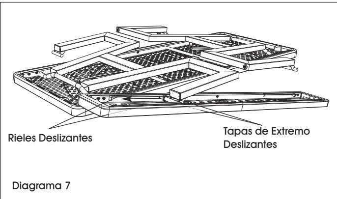
9. Coloque un asiento para banca debajo de una de las patas y pase las tapas deslizantes por los rieles deslizantes que están debajo del asiento para banca. (Vea Diagrama 7)
