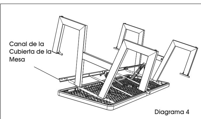
6. Vuelva a colocar el canal de la mesa en su lugar. Mientras una persona sostiene las patas, utilice el taladro para reinsertar los cinco tornillos que quitó en el paso 1 dentro de los orificios del canal de la cubierta de la mesa para fijarlos en su lugar. (Vea Diagrama 5)
