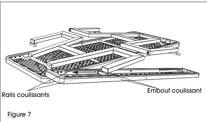
9. Installez un banc sous l'un des pieds, puis faites glisser les embouts coulissants sous les rails coulissants du banc. (Voir Figure 7)
