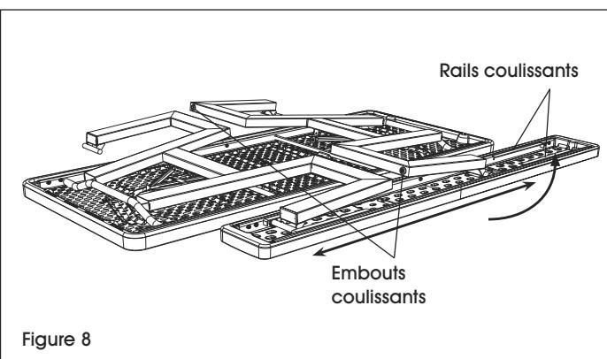
10. Fixez deux embouts coulissants sur le tube de l'autre pied de table, puis soulevez le banc jusqu'à ce que les embouts coulissants demeurent dans le dessous du banc. Placez le banc de façon à ce que les quatre embouts soient sous le rail coulissant. (Voir Figure 8)
