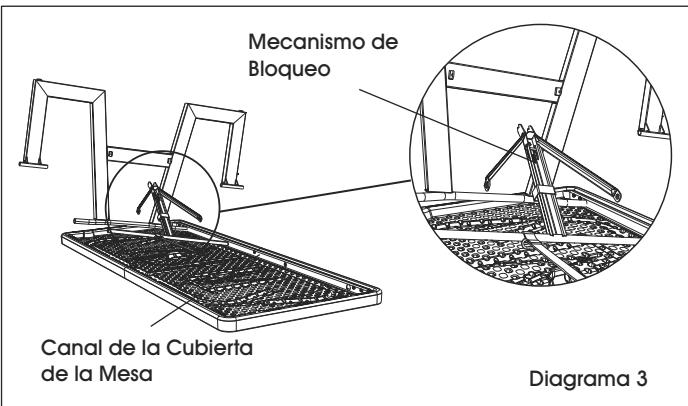
3. Inserte un ensamble de pata y un soporte para ensamble de patas dentro de los orificios grandes que están a lo largo del canal de la cubierta de la mesa que está aún conectada a la cubierta. (Vea Diagrama 3)
