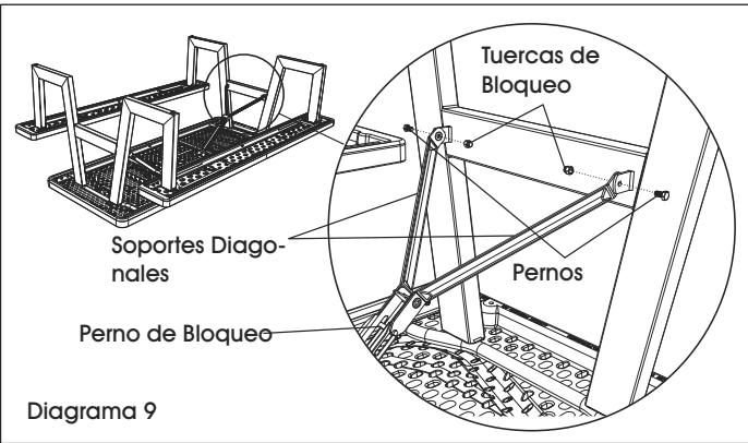
12. Enderece uno de los ensambles de pata y deténgalo en su lugar. Una segunda persona girará los soportes diagonales del soporte de ensamble de pata hasta que el perno de bloqueo entre a presión dentro de las marcas localizadas al extremo de los soportes diagonales. Conecte los extremos de los soportes diagonales al ensamble de las patas usando dos pernos y dos tuercas de seguridad. (Vea Diagrama 9)
