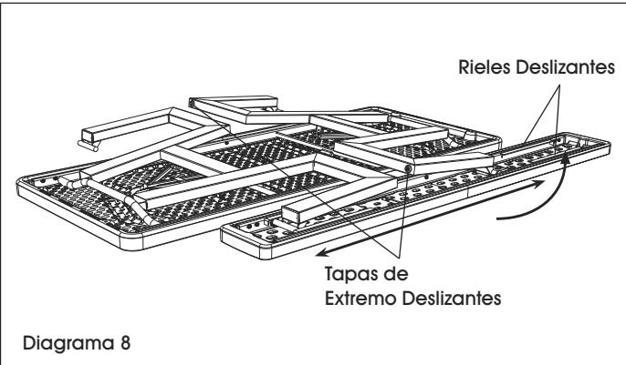
10. Acople dos tapas deslizantes al tubo que está en la otra pata de la mesa, levante el asiento de la banca hacia adelante hasta que las tapas deslizantes se queden dentro de la parte inferior de la banca. Coloque la banca de forma que las cuatro tapas deslizantes se encuentren debajo del riel deslizante. (Vea Diagrama 8)
