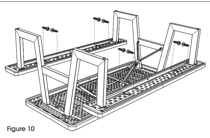
14. Pendant qu'une personne maintient les pieds de table en position verticale, insérez quatre vis dans le banc à travers les trous des profilés du banc afin de garder les embouts coulissants sous les rails coulissants. (Voir Figure 10)
