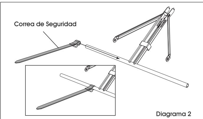
2. Si la correa de seguridad aún no está unida al soporte para ensamble de patas, deslice la correa de seguridad sobre el tubo del soporte para ensamble de patas como se muestra. Asegúrese de que la correa de seguridad esté orientada con el anillo de metal hacia abajo como se indica. (Vea Diagrama 2)
