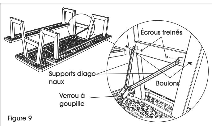
12. Soulevez un ensemble de pieds en position verticale et maintenez-le en place. Une deuxième personne doit faire pivoter les supports diagonaux de l'ensemble des renforts de pied jusqu'à ce que le verrou à goupille s'enclenche dans les encoches situées à l'extrémité des supports diagonaux. Connectez les extrémités des supports diagonaux à l'ensemble de pieds à l'aide de deux boulons et deux écrous freinés. (Voir Figure 9)
