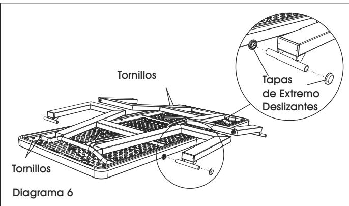
7. Coloque las patas y los soportes de las patas de la mesa sobre la parte superior de la mesa. (Vea Diagrama 6)
