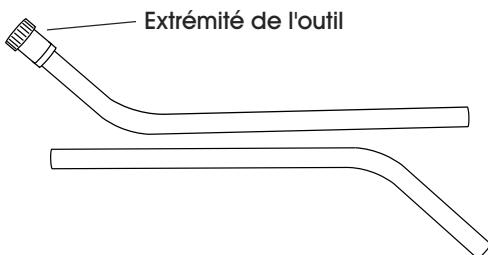
2. Alignez les extrémités des tubes rallonges comme illustré et fixez-les en les enfonçant l'un dans l'autre jusqu'à ce que vous entendiez un déclic et que la goupille de verrouillage du bouton-poussoir passe à travers le trou. (Voir Figure 4)
