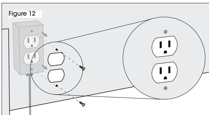
**REMARQUE : Le matériel d'installation est livré préinstallé sur la prise.**
