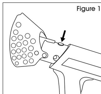
2. Raccordez la chambre de combustion à l'extrémité de la rallonge et vérifiez qu'elle est bien verrouillée en place par le bouton n° 31. (Voir Figure 2)
