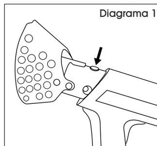
2. Ensamble la cámara de combustión en el extremo de la extensión y confirme que esté bien asegurada en su lugar mediante el botón #31. (Vea Diagrama 2)
